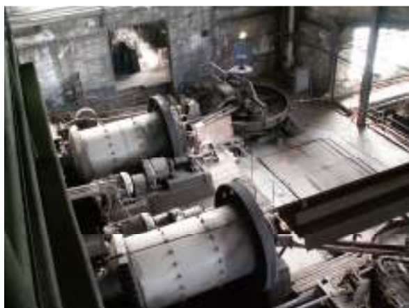
Kulkvarnarna krossar malmen till pulver med hjälp av järnkulor.
